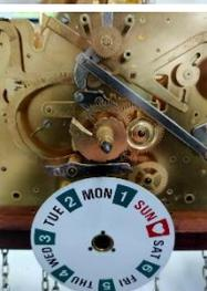
部品をひとつひとつ丁寧に磨き、壊れた部品を手作りで直して頂き、正確な時を取り戻しました。
